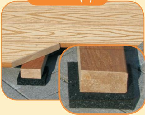
ISOPAT wird punktuell in Abständen unterlegt, wenn die Tragbalken quer zur Wasserfließrichtung verlegt werden, oder unter die Ecken von Holzfliesen bzw. Steinplatten. Der Abfluss von Wasser und Verschmutzung wird somit nicht behindert. Pro m<sup>2</sup> werden ca. 5 Isopats benötigt.
